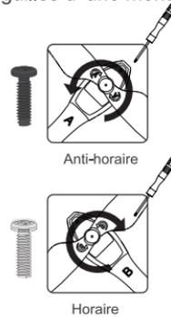
2) Remplacement: Si les hélices doivent être changées, veuillez procéder comme indiqué ci-dessous avec un tournevis. Les hélices A sont jumelées à des axes moteur A et se dévissent dans le sens des aiguilles d'une montre. Les hélices B sont apparées avec les axes du moteur B et se dévissent dans le sens anti-horaire.
