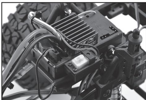
L'ensemble variateur/récepteur se situe à l'arrière de la voiture. Mettre l'interrupteur sur ON comme montré sur la photo.
