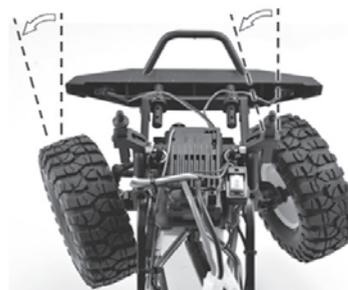
Ce réglage ajuste la course du servo de direction. Pousser le bouton en avant pour un maximum de directivité. Tirer en arrière pour réduire la course du servo.
