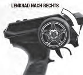
3.) Um das RC-Modell nach rechts zu lenken, muss das Lenkrad entsprechend nach rechts gedreht werden. Möchte man eine möglichst enge Kurve fahren, muss das Lenkrad bis zu seinem Vollausschlag gedreht werden.
