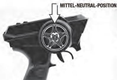
1.) Um das RC-Modell geradeaus fahren zu lassen, muss das Lenkrad einfach nur in Mittel-Neutral-Position stehen gelassen werden.
