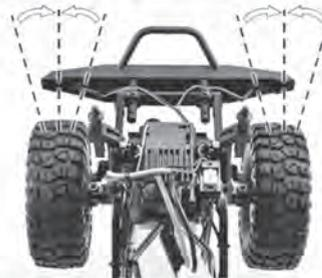
Fahre Dein RC-Modell ohne das Lenkrad zu benutzen vorsichtig und langsam einer gerade Linie auf dem Boden entlang. Fährst es dabei z.B. nach links, musst Du den „ST-TRIMM“ Drehknopf solange in kleinen Schritten nach rechts drehen, bis das RC-Modell genau geradeaus fährt. Im umgekehrte Fall, musst Du logischerweise entsprechend umgekehrt verfahren.
