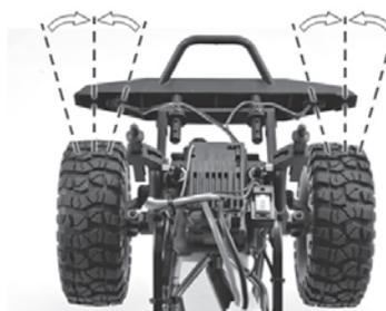
Placer la voiture sur le stand avec les roues qui ne touchent pas le sol, puis régler le Trim de direction pour aligner les roues avant.
