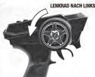
2.) Um das RC-Modell nach links zu lenken, muss das Lenkrad nach links gedreht werden. Dabei ist der Lenkausschlag der Räder direkt proportional zu Einschlag des Lenkrades; d.h. möchte man eine weite, langgezogene Kurve fahren, reicht ein kleiner Ausschlag des Lenkrades aus.
