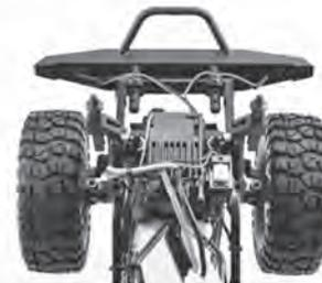
Wenn der Gashebel am RC-Sender sich in seiner Mittel-Neutral-Position befindet, sollte das RC-Modell im Normalfall stillstehen. Macht es dennoch Anstalten, sich vorwärts oder rückwärts in Bewegung setzen zu wollen, dreh man in kleinen Schritten am „TH-TRIMM“ Drehknopf, bis es absolut stillsteht.
